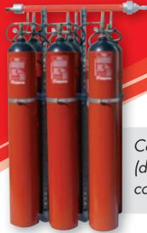
Composé de 50% d'Azote (N) et 50% d'Argon (Ar), l'A2+ réduit la concentration d'oxygène contenu dans l'air (de 21% à 12%) et étouffe rapidement le feu tout en conservant une atmosphère respirable pour les personnes en cours d'évacuation.
